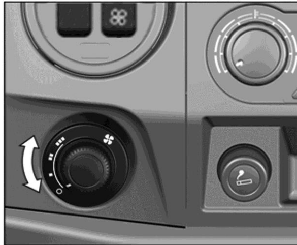
Рис. 7.37. Установка переключателя дополнительного отопителя
