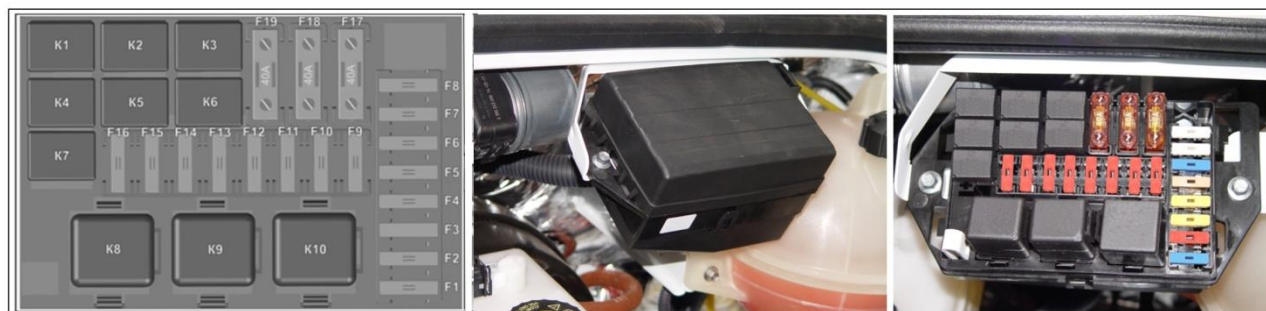
Рис. 7.49. Установка блока реле и предохранителей, расположенного в моторном отделении
