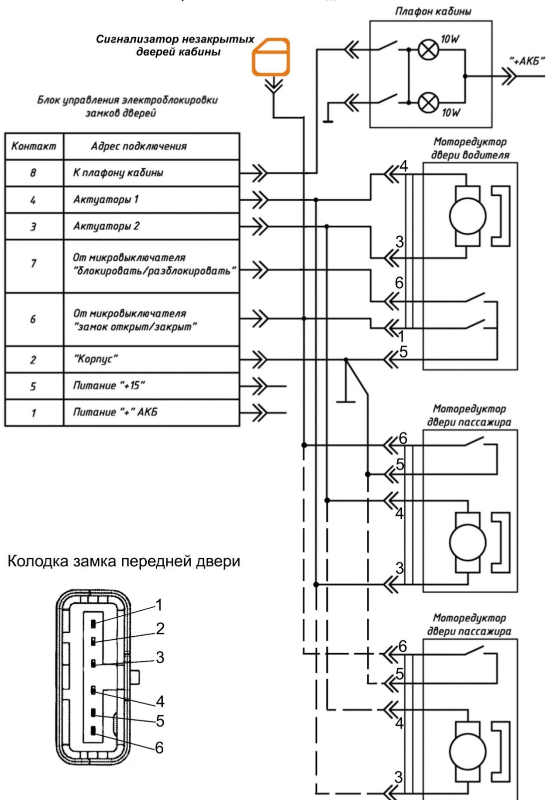
Рис. 7.41. Электрическая схема подключения блока управления C41R11.3867100 системой блокировки дверей
