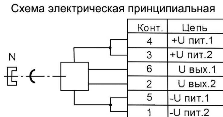
Рис. 7.55. Схема электрическая модуля педали акселератора
